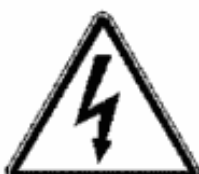
Tensione elettrica pericolosa
